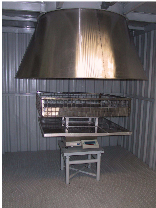
Figura 3 - Balança e prato para testes de queima de biomassa, e boca da chaminé.
